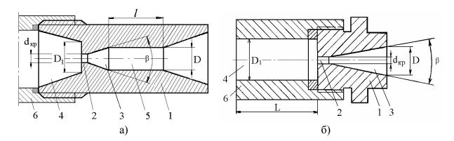
а – конструкция ГК с преддиффузорным и последиффузорным каналами; б – конструкция ГК с преддиффузорным каналом; 1 – генератор кавитации; 2 – критическое сечение; 3 – диффузор кавитационной камеры; 4 – преддиффузорный проточный канал; 5 – последиффузорный проточный канал; 6 – труба
